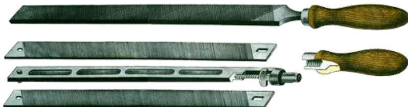
Рис. 1.7.9. Безпечна рукоятка напилків
